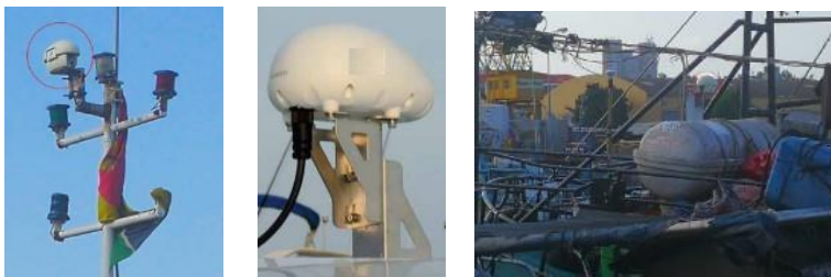
Figura 26: Exemplos de dispositivos VMS (a esquerda: modelo LEO; a direita: modelo VMS tipo Thorium, de primeira geração)
